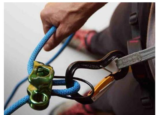
En fin de prestation, tirer sur la bague orange permet aisément de sortir la corde.
