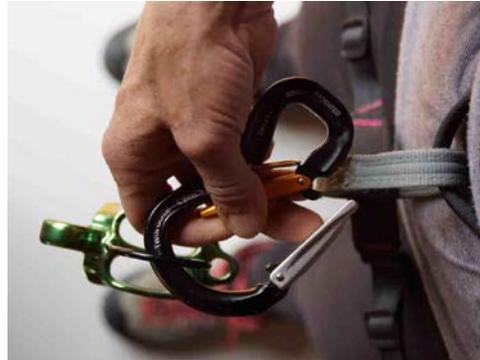
Ensuite, on laisse faire. Le pontet se glisse sous le doigt directionnel qui s'ouvre automatiquement (mise en place rapide et aisée).
